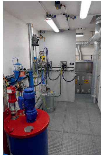
Gefahrenstoffcontainer mit Mischanlage, flexibler 3K Lackieranlage, Arbeits- und Reinigungstisch – Individuell auf Kundenwunsch
